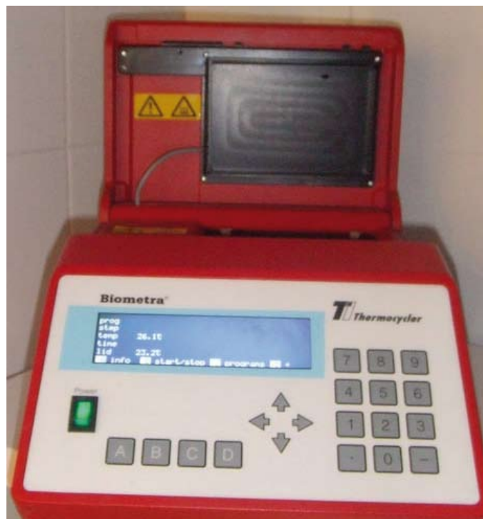
Fig 5. Programador de tiempos y temperaturas para realizar los ciclos de la amplificación por PCR.
