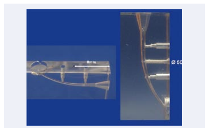
Fig.3: Se realizó un conducto lateral de diámetro 50 a 8mm. de la entrada del conducto principal.
