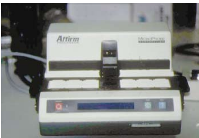
Fig. 2.— Periotron 6000. Para determinación del volumen de fluido crevicular recogido por las tiras de papel introducidas en el surco.
