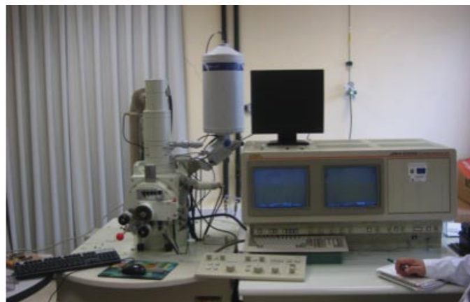
Imagen 5: Microscopio Electrónico de Barrido (JEOL JSM 6300).
