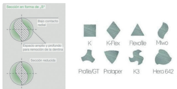
Figura 2. Sistema Mtwo®, sección transversal en forma de S itálica. Sistema Profile®, sección de corte transversal triple "U". Extraída: Catálogo Dentaltix.
