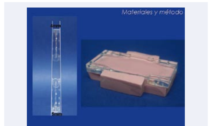
Fig. 2: Vista lateral del bloque donde se aprecia su forma trapezoidal. Para corregir esa diferencia de anchura, se confeccionó un soporte de silicona.
