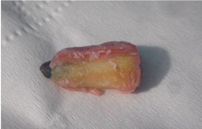
Foto n° 8. Eliminación de la capa de cera.
