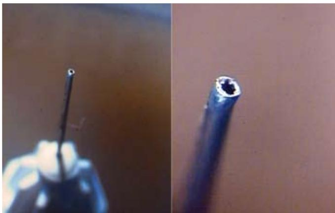
Figura 3 (3a-3b). Aguja fracturada por defecto de fabricación durante las maniobras de una anestesia troncular. Fotografías cortesía del Dr. José María Vega del Barrio.
