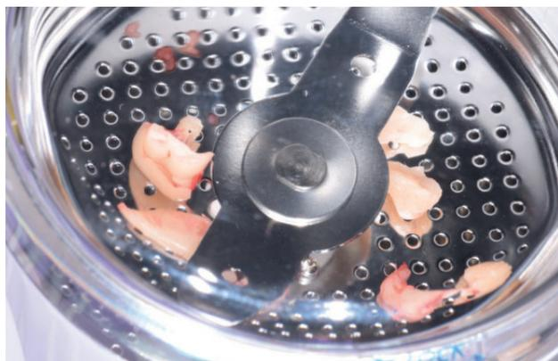
Figura 14. Fragmentos coronales y radicales introducidos en la máquina Smart Dentin Grinder®.
