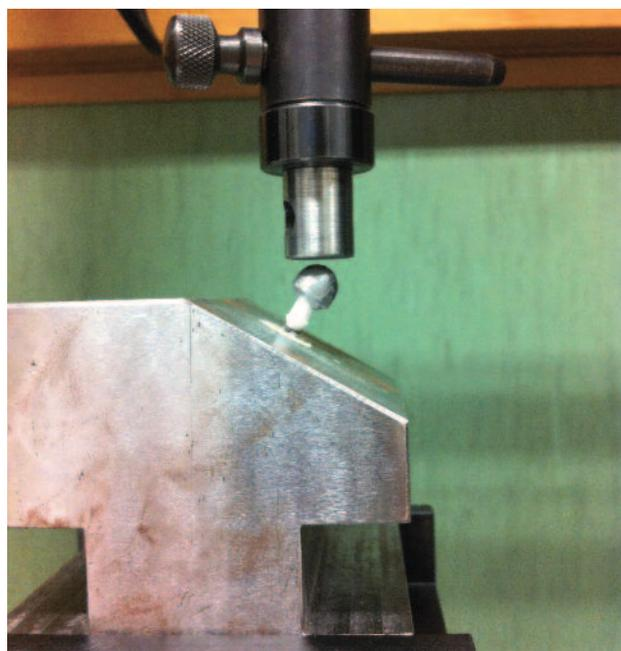
Figura 2. Montaje para ensayo de resistencia estática.
